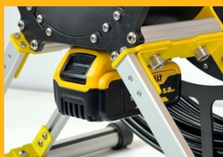
BATTERIDRIFT Kompatibel med batterier från Makita, DeWalt, Hilti
